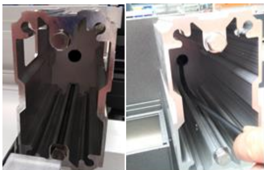
Fig. 8b Trous pour le câblage
